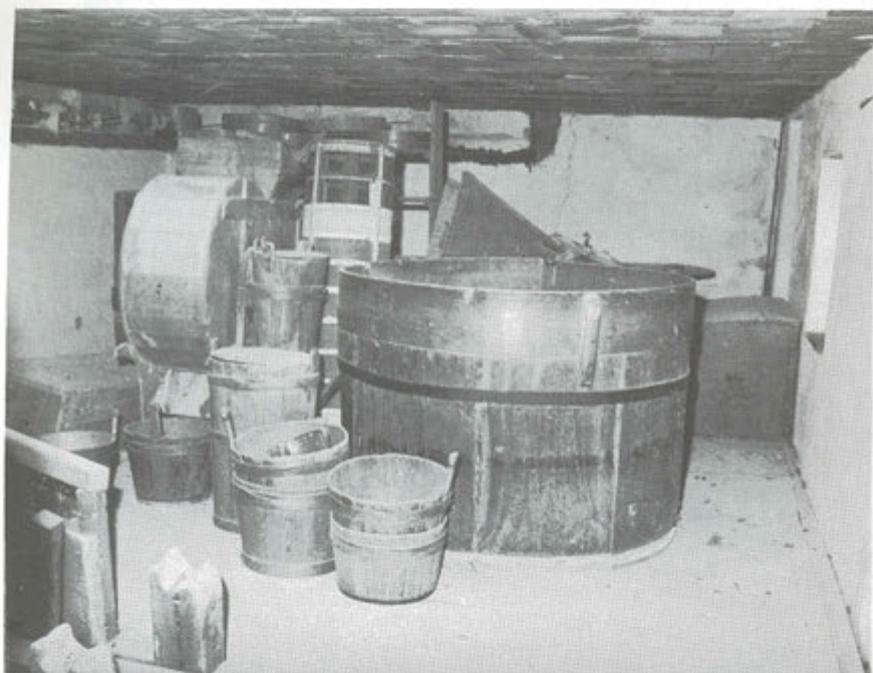
*Fig. 6: Particolare del soppalco (pàut): si intravede sulla destra il pestino a mole (pestìn) e sulla sinistra il ventilabro meccanico (molin da vent). In primo piano il cavalletto per la rabbigliatura dei palmenti (ciàura), congeiali (portadoe) e misure per il cereale (stè).*
