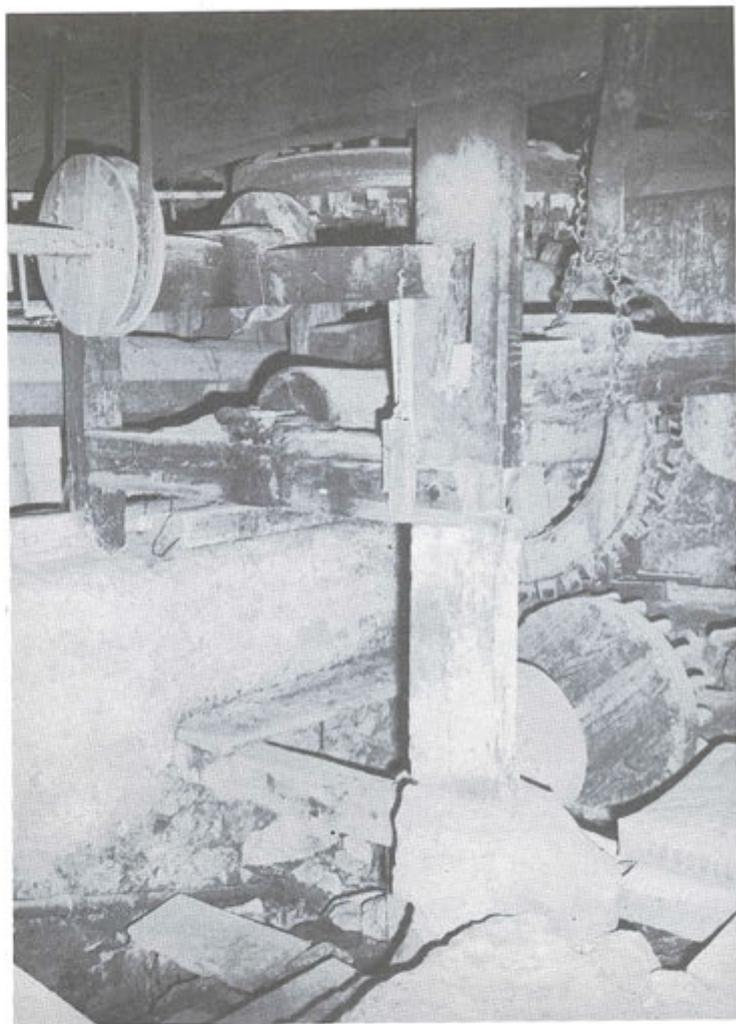
*Fig. 5: Particolare dell'ingranaggio a lubecchi che aziona il pestino a mole (pestin). A destra in basso si intravede una mole per affilare gli strumenti a taglio del mulino e la cinghia di trasmissione del movimento rotatorio dell'albero della ruota al ventilabro meccanico (molin da vent).*
